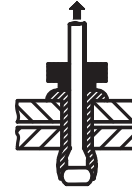
Bohrlochfüllung drill hole filling
